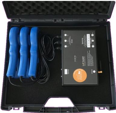
Mobile Messbox zur Aufzeichnung der elektrischen Energie.
